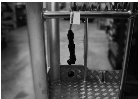
Fig. 168 Serviceaansluiting op hoogwerkerbak
