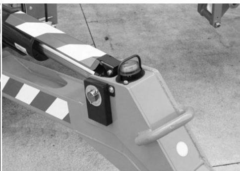
Fig. 106 Controlelampje stempel op de grond
