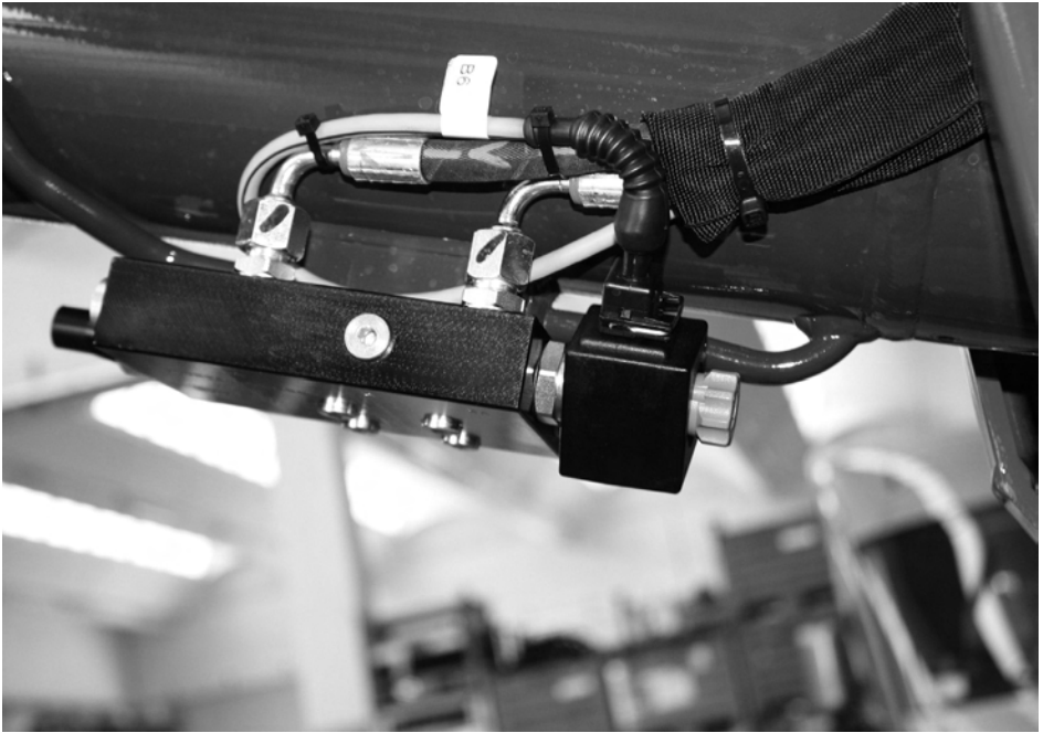
Fig. 72 Elektrokleppen voor de nooddaling wegens ernstige situatie
