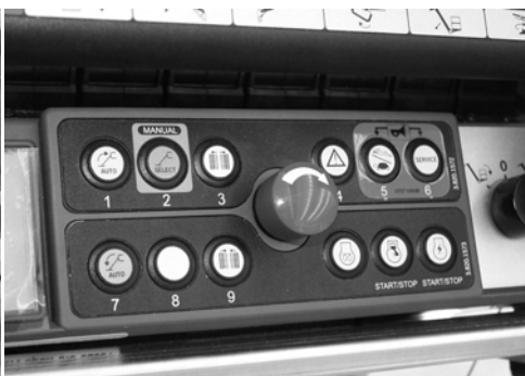
Fig. 67 Noodstop op de afstandsbediening
